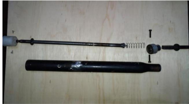
Figura 5: Detalhamento da barra de direção. Fonte: Autor, 2018.
