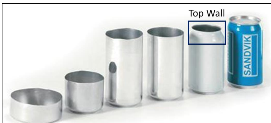
Figura 1 - Sequência operacional aproximada do processo de fabricação de latas de alumínio
